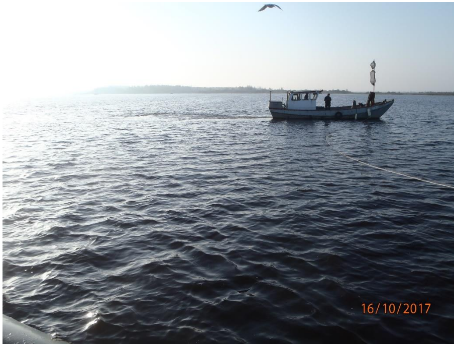
Figuur 14 De stortkuil werd met twee boten voortgesleept. Om tijdens het vissen de afstand tussen de twee boten constant te houden, werd er een touw tussen de twee boten gespannen.
